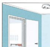
Brandvarnaren ska sitta i taket.
