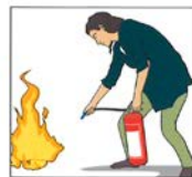
Sikta med slangen mot botten på branden.
